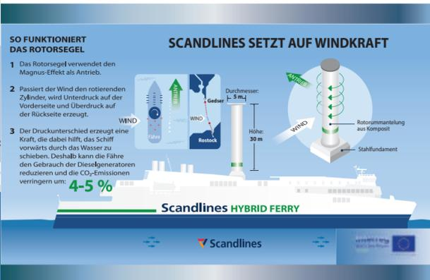
Das Rotorsegel ist ein rotierender, 30 Meter hoher Zylinder, dessen Technologie auf dem sogenannten Magnus-Effekt basiert. Der Unterschied in der Windgeschwindigkeit auf beiden Seiten des Zylinders führt zu einem Druckunterschied, der eine Kraft senkrecht zum Wind generiert. Es ist diese Kraft, die dabei hilft, das Schiff vorwärts durch das Wasser zu schieben.
