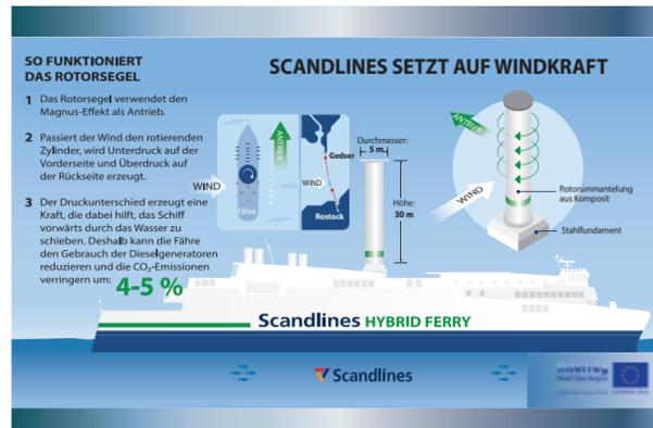
Das Rotorsegel ist ein rotierender, 30 Meter hoher Zylinder, dessen Technologie auf dem sogenannten Magnus-Effekt basiert. Der Unterschied in der Windgeschwindigkeit auf beiden Seiten des Zylinders führt zu einem Druckunterschied, der eine Kraft senkrecht zum Wind generiert. Es ist diese Kraft, die dabei hilft, das Schiff vorwärts durch das Wasser zu schieben.
