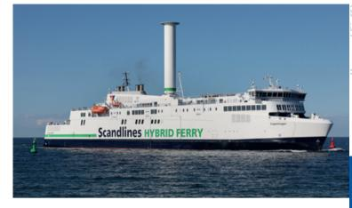
Das Rotorsegel ist ein rotierender, 30 Meter hoher Zylinder, dessen Technologie auf dem sogenannten Magnus-Effekt basiert. Der Unterschied in der Windgeschwindigkeit auf beiden Seiten des Zylinders führt zu einem Druckunterschied, der eine Kraft senkrecht zum Wind generiert. Es ist diese Kraft, die dabei hilft, das Schiff vorwärts durch das Wasser zu schieben.
